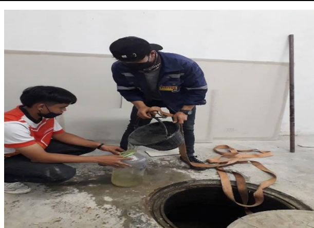
รูปที่ 4.5-2 พนักงานเก็บน้ำระบบบำบัดเพื่อตรวจสอบ
